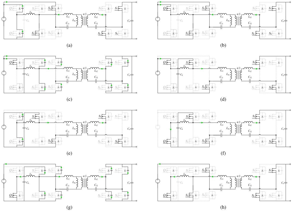
Fig. 5. Detailed waveforms. (a) Before t_0 . (b) [t_0, t_1) . (c) [t_1, t_2) . (d) [t_2, t_3) . (e) [t_3, t_4) . (f) [t_4, t_5) . (g) [t_5, t_6) . (h) After t_6 .
