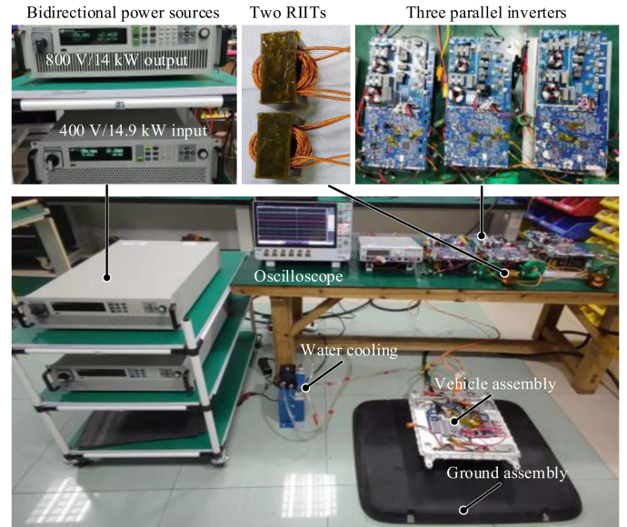
Fig. 16. A 14-kW RIIT-MI LCC-LCC WPT prototype.
