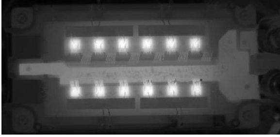
Fig. 3. Example IR thermal image of a GE SiC module.
